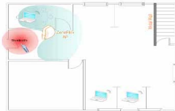
AP 通过改变传输路径，将信号有效覆盖到承重墙后边的区域。
