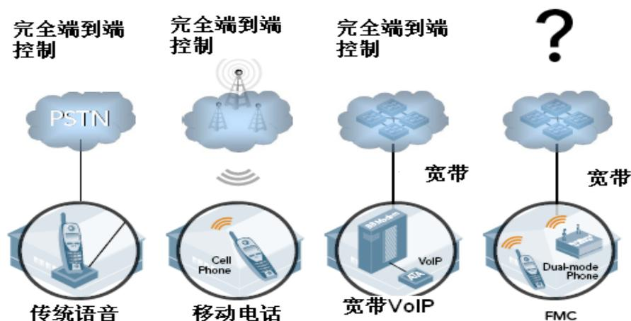
不过，FMC 也对过去对语音连接具有完全端到端控制的运营商提出了一些新的挑战（见前图）。新的双模手机同时支持 Wi - Fi 和蜂窝技术，由于干扰和 QoS 问题，完全的端到端控制已经不可能。
