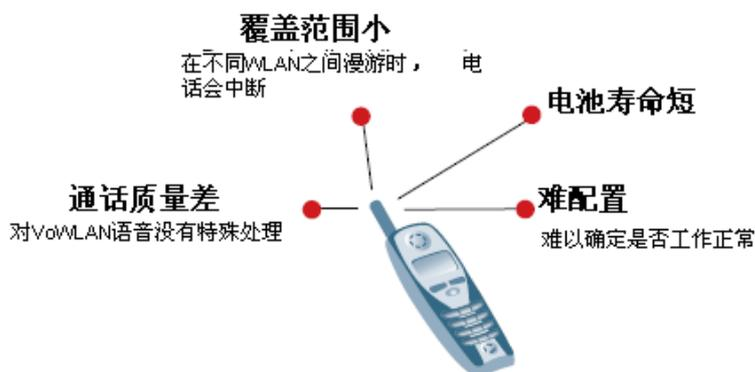
通常传统的 AP 在所有时间都以最高的功率发射，希望可以“强行通过”传输路径上降低信号和范围的干扰和障碍。但结果是，WiFi 手机的电池很快耗光，同时增加 Wi - Fi 使用者之间的干扰。
