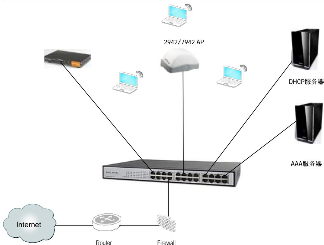
部署在大楼内的 2942 AP，通过以太网线连接到楼层以太网交换机或通过大楼的综合布线系统直接连接到大楼设备管理间的以太网交换机。如果楼层有些地方难以实施综合布线，则可以考虑采用 Ruckus 无线公司的智能 MESH 技术，2942 AP 只需部署到所需的位置，通过 220V AC/DC 电源适配器对其进行供电，2942 AP 会自动发现周围邻居，并自动发现一条最佳的路径连接到有线网。
