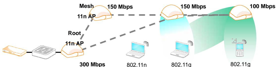
如果采用 Ruckus 无线公司智能 MESH 技术，则可以大大降低施工的难度，降低工程成本，加快工程建设进度。这项技术对于已装修的大楼或临时增加无线覆盖的应用场景尤为重要。由于无线 MESH 网经过多跳后，性能会下降。如采用 Ruckus 无线公司 2942 11g AP，经过
