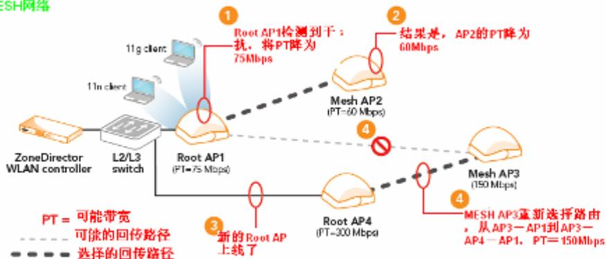
Ruckus 的 SmartMESH 是自动愈合的无线 MESH 网络。其智能 AP 会一直尝试找到一个最佳信号路径以避免干扰，从而防止数据包丢失和维护更高的传输速率。如果不能找到一个符合传输质量的信号路径，如果检测到上游 AP 的性能急剧下降，下游 SmartMesh 的 AP 上的自动拓扑软件（见下图）将会自动地重新找到新的回传路由。
