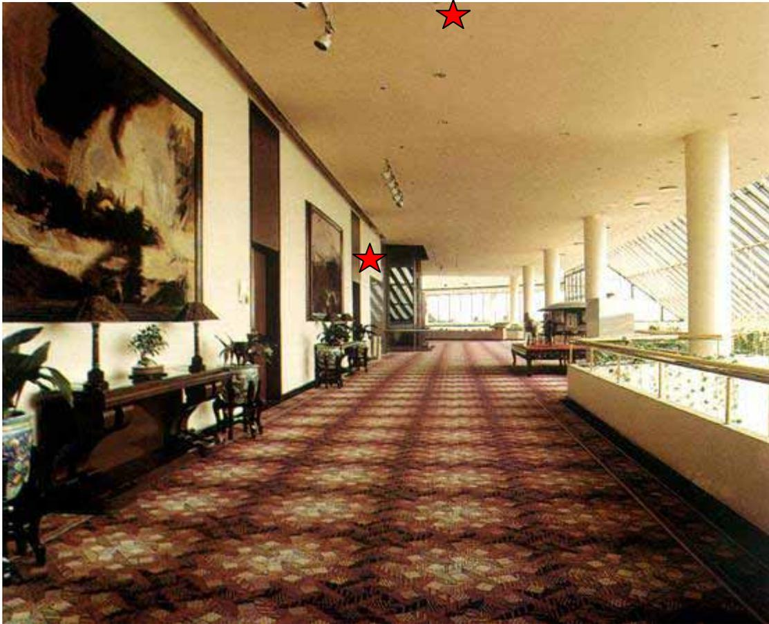
AP 可以布置在吊顶或墙面上，形成对走廊的信号覆盖。
