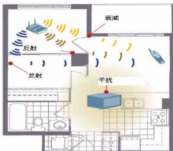
Wi-Fi 网络还受隐藏节点和多路径传输的影响。多路径传输的发生是因为无线电波在发送端和接收端传送时，会以一定的角度反射，特别是液体或金属表面（例如，百叶窗，电器，门）。多次反射的相同的信号可能都会达到接收端，在那里的增强，减弱，无效或破坏的主信号。这种常见的现象，造成信号严重退化和覆盖漏洞。即使传输的条件保持不变，避免多径衰落也是困难的。不过，射频环境的变化不断，从微波炉产生噪音，到人移动时产生的突发噪声，都会改变无线电波在室内的传播。即使是很小的环境变化可能对性能产生巨大影响。
