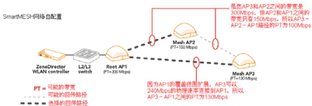
Ruckus 的 SmartMESH 网络是自动优化的网络。SmartMESH 网络中的智能 Ruckus AP 会不断检测其工作环境和上行链路的带宽状况，自动地实时地选择最佳的回传路径，以使整个无线 MESH 网络具有最佳的性能和最好的稳定性、可靠性。
