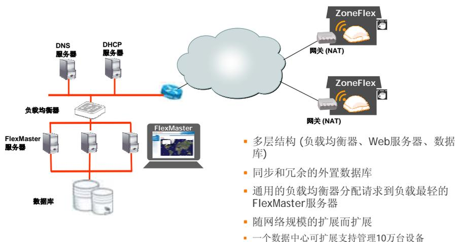
进一步的网络扩展和系统冗余备份则是分布式数据中心冗余，分别部署 FlexMaster 集中网管系统在地理冗余的不同数据中心，北部地区的 AP 则配置网管 URL 到部署在北部数据中心 FlexMaster 的 URL，同样南部地区的 AP 则配置网管 URL 到部署在南部数据中心 FlexMaster 的 URL，利用 AP 上配置不同 FlexMaster 服务器 URL 来做适当的负载均衡。
