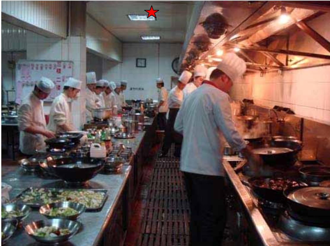
AP 可以布置在吊顶或墙面上，形成对厨房的信号覆盖。厨房对数据通讯要求不高。虽然环境对无线信号很恶劣，但要求的通讯速率不是很高，所以可以 AP 的布置可以不用太密集。
