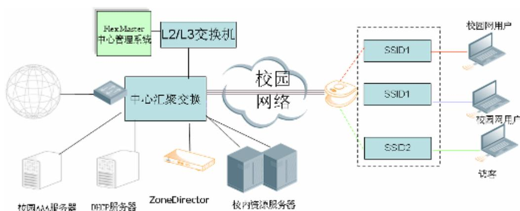
无需重新布线或划分 VLAN，AP 就近接入现有网。在网络的中心或集中交换机处部署无线控制器 ZoneDirector，对 AP 进行同一的 AP、用户接入、安全和无线 RF 管理。
