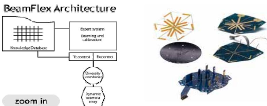
支持 BeamFlex 的 Ruckus AP 通过检测射频和多径问题以及邻居网络噪声带来的干扰，能够实时重新自行配置和调整。通过为每一个接收设备选择一个优化的天线阵列，BeamFlex 能够扩展无线覆盖范围并提供更高的通讯速度。利用 BeamFlex 天线系统的大量分集功能，可使 Ruckus AP 在一个不断变化的环境中从多种不同质量的信号传输路径中实时选择一个最优的传输路径。这一能力为语音和视频应用提供了稳定一致的性能基础。
